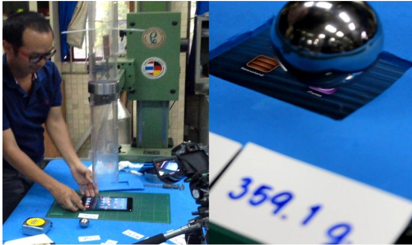
รูปที่ 2 การทดสอบการทนต่อแรงกระแทกของหน้าจอ iPad mini
