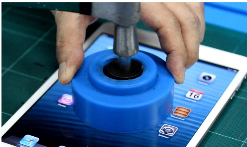
รูปที่ 3 การทดลองทุบสลักเหล็กบนหน้าจอ iPad mini ที่ติดฟิล์มกันกระแทก
