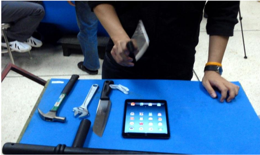
รูปที่ 7 การทดสอบหน้าจอ iPad mini ที่ติดฟิล์มกันกระแทก (Focus: Anti-Shock) ด้วยมีดปังตอ
