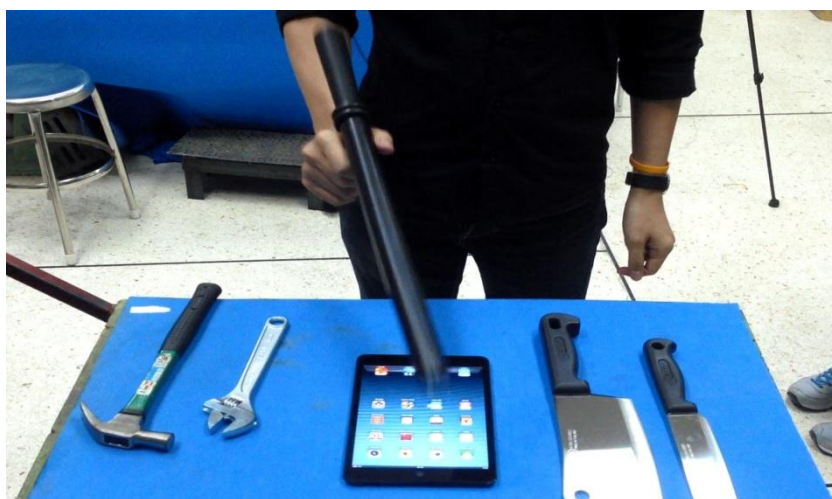
รูปที่ 6 การทุบหน้าจอ iPad mini ที่ติดฟิล์มกันกระแทก (Focus: Anti-Shock) ด้วยกระบองไม้
