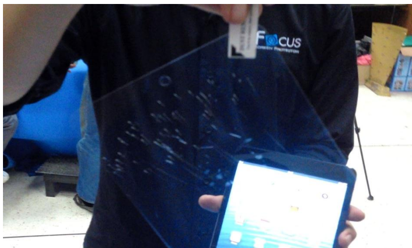
รูปที่ 12 ร่องรอยความเสียหายบนผิวหน้าของแผ่นฟิล์มกันกระแทก (Focus: Anti-Shock) หลังการทุบ
