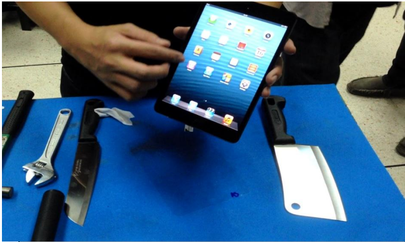
รูปที่ 13 สภาพหน้าจอ iPad mini เมื่อลอกแผ่นฟิล์มกันกระแทก (Focus: Anti-Shock) ออก
